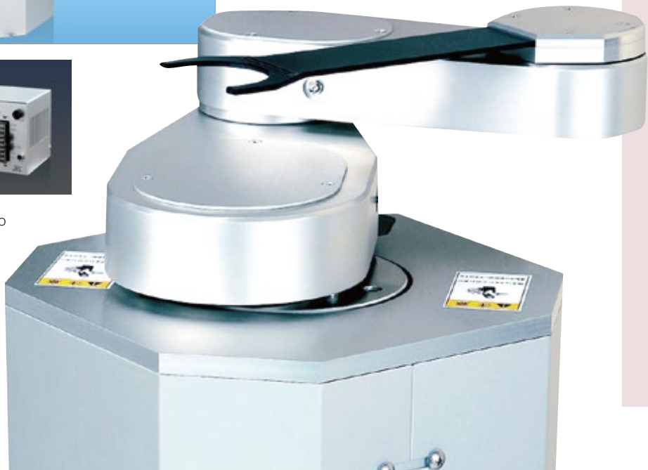
控制器:C4000 ●控制方式:RS232C及並列埠I/O
